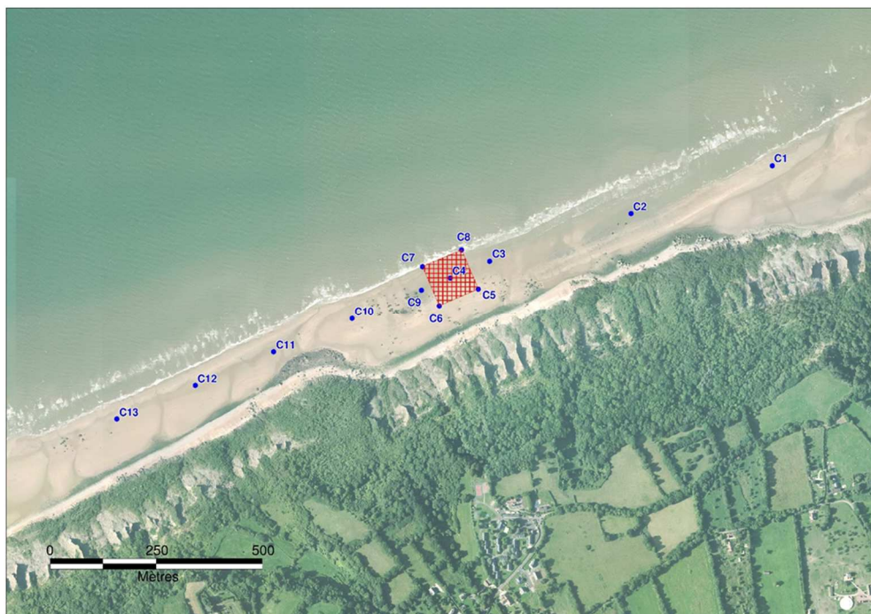
Figure 7 : Plan d'échantillonnage des points de carottage
