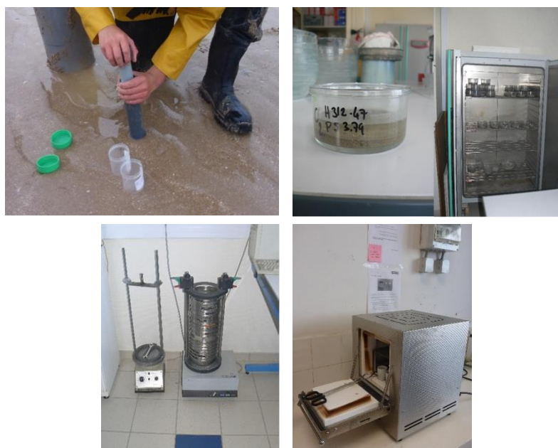
Figure 9. Prélèvement de sédiment sur le terrain et détermination des caractéristiques granulométriques et de la teneur en matière organique au laboratoire du GEMEL-Normandie.
